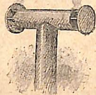
Extrémité supérieure de la cheminée, ornée d'abat-vent.
